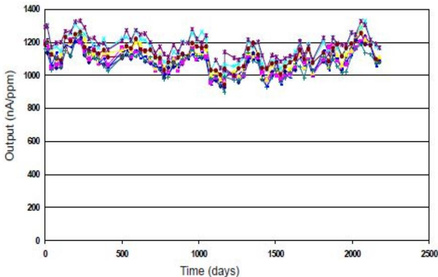
基于已获专利的产品设计、优越的电化学特性以及自动过程控制，H2S-AH传感器表现出优良的灵敏度长期稳定性，如图4所示。
