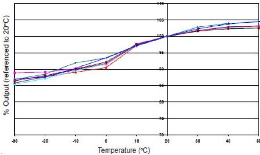
图2显示了由温度变化引起的传感器灵敏度改变。
