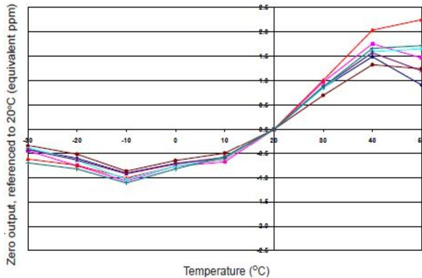
图3显示了由温度变化引起的零点输出变化，用等效的ppm值表示，参考20°C的零点。
