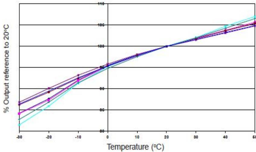
图2显示了温度变化时传感器对25ppm HCl的灵敏度改变。
