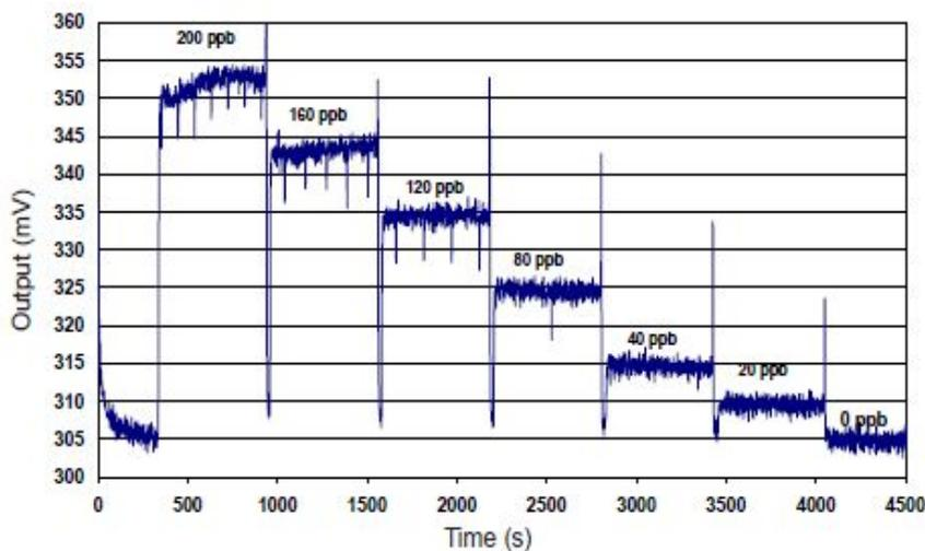
图4所示为传感器对200~0ppb NO的反应。测试采用AFE电路板。
