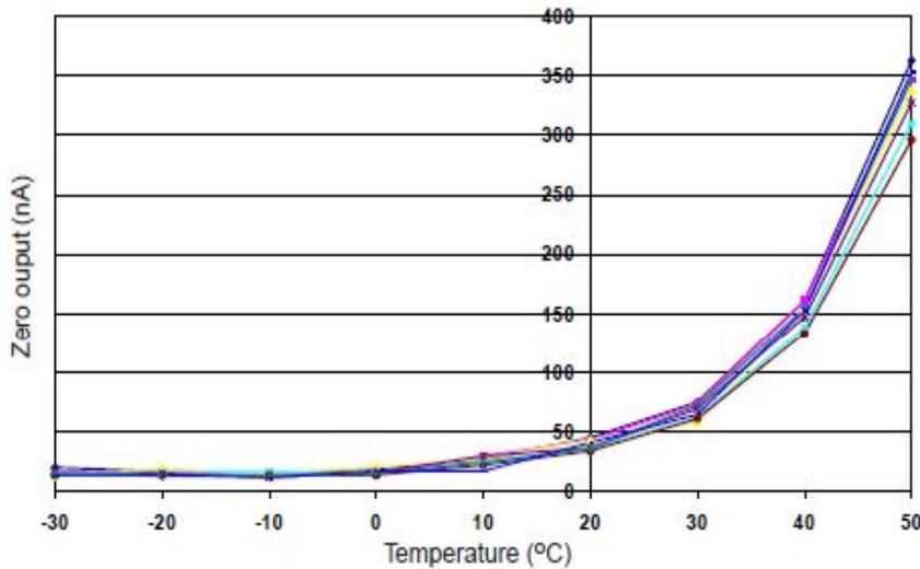
图3 显示了由温度变化引起的零点输出变化，单位为nA。
