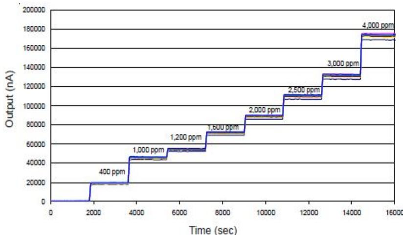
图4显示了将CO浓度逐步增加至规定过载CO浓度两倍的过程中，传感器的输出变化。数据来源于8只典型批次中的传感器。
