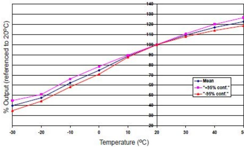
图2 显示了由温度变化引起的灵敏度变化。在升温过程中，输出表现出可重复的温度特性，使得我们能对温度做更精确地补偿。
